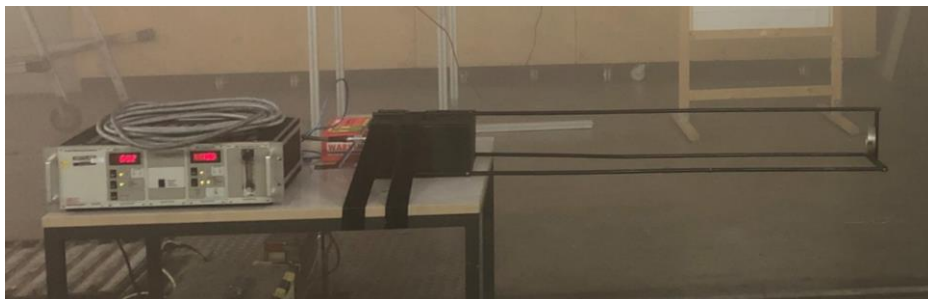
Abbildung 8.9: Extinktionsmessgerät mit 1 m langem Auslegearm (rechts) und Messequipment (links)
