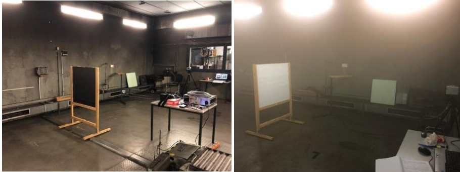
Abbildung 8.8: Aufbau im Brandlabor ohne Nebel (links) und mit Nebel (rechts)
