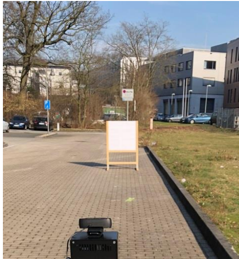
Abbildung 8.5: Messaufbau im Außenbereich mit dem Owl-System im Vordergrund und dem weißen Target im Hintergrund
