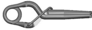
Abbildung 17: CAD-Modell des in dieser Studie verwendeten Aneurysma-Clips. (Nachdruck von Nouredine et al., 2018)
