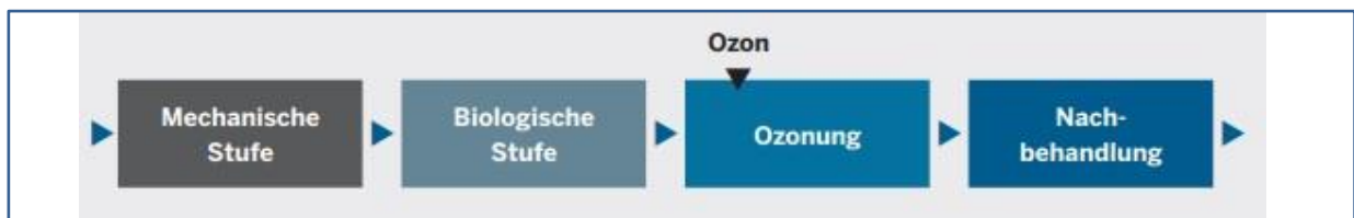
Abbildung 11: Verfahrensordnung der Ozonung nach KOM-M.NRW (2016)
