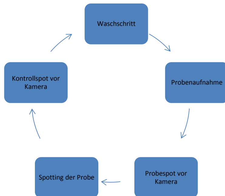
Abbildung 13: Darstellung des Spotting-Prozesses mit automatisierter Abfolge. Nach einem Waschschrift und der Probenaufnahme in die Nozzle des Spotters aus der SciSourcePlate erfolgt ein Probespot mit gleichzeitiger Qualitätskontrolle der Tropfenform vor der Kamera, gefolgt vom Spotting der Probe in den Kanal und anschließendem Kontrollspot vor der Kamera. Nach einem Waschschrift wird die nächste Probe aufgenommen und der Ablauf wiederholt sich.
