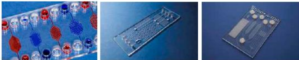
Abbildung 8: Beispiele für mikrofluidische Chips. Auf der linken Seite befindet sich ein „Pillar“-Chip, der zur Filterung bestimmter Bestandteile oder Füllung per Kapillarkräften verwendet werden kann, in der Mitte ein Chip für einen kompletten SELEX-Prozess und rechts ein Chip zur Durchfluss-PCR mit parallelem Immunoassay (microfluidic ChipShop GmbH, 2016).
