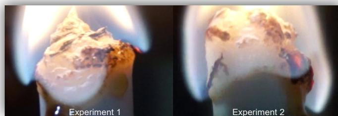
Abbildung 5-36: Polymeroberflächen von Proben aus zwei unabhängig voneinander durchgeführten Experimenten zur Temperaturmessung mit jeweils 5 Gew.-% Additivanteil. Die fotografischen Aufnahmen entstanden unmittelbar nachdem die Koksschicht manuell entfernt wurde. Experiment 1 und 2 zeigen starke Unterschiede in der Oberflächenstruktur.
