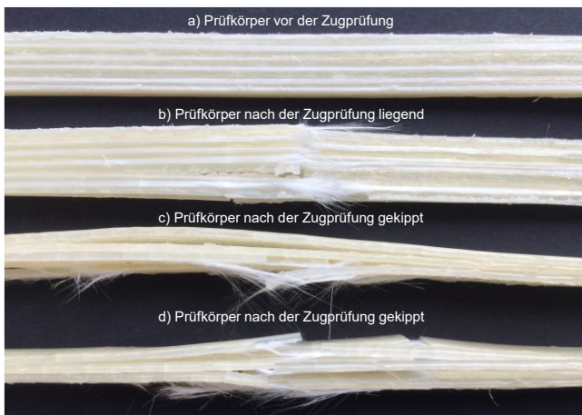
Abbildung XII-5-95: Prüfkörper PA 6 B32 + Hybridgarn 480 tex vor und nach der Zugprüfung
