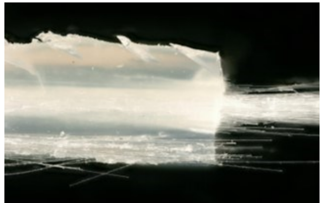
Abbildung XII-5-101: Glasfaser Pull-Out Effekt in einer thermoplastischen Einzelbahn
