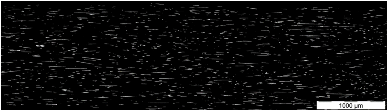
Abbildung XIV-1-1: Kurzfaservororientierung Filament PA 6.66 CF10 KFA (siehe Abbildung XII-3-24)
