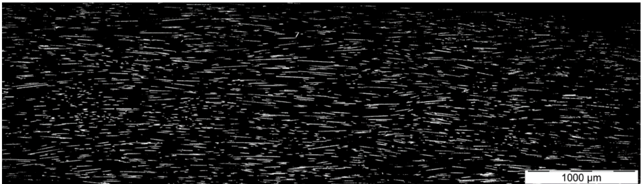
Abbildung XIV-1-2: Kurzfaservororientierung Filament PA 6 CF20 KFG (siehe Abbildung XII-3-25)
