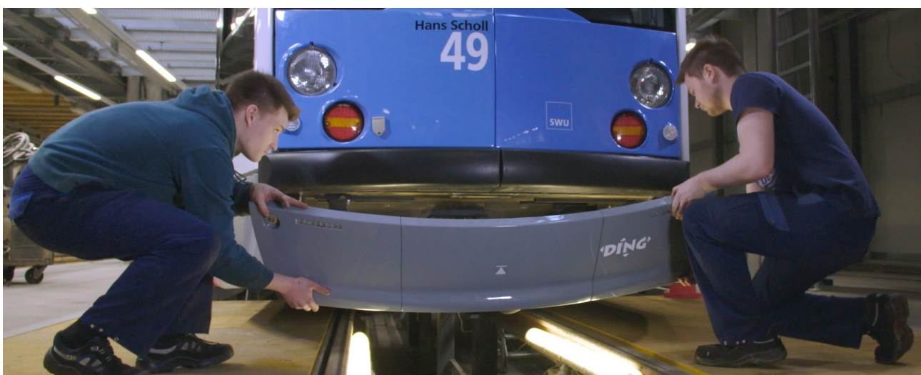
Abbildung XII-1-1: Montage der additiv gefertigten Frontschürze aus [76]
