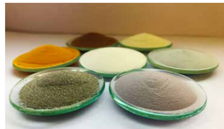
Der Pulver-Rohstoff, beschichtet mit unterschiedlichen Nanopartikeln für den 3D-Laserdruck in verschiedenen Farben.
