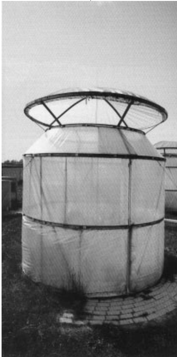
(3) Open-Top-Anlage des Instituts für Angewandte Botanik. System zur Exposition von Pflanzen gegenüber Luftverunreinigungen unter naturnahen Bedingungen.
