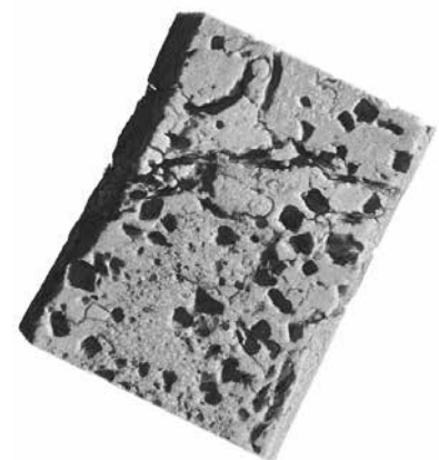
(3) Mikrocomputertomographische Aufnahme ( \mu CT) einer porösen Calciumphosphat-Keramik für den Knochenersatz mit Poren im mm-Bereich. Das Objekt ist ca. 1,5 mal 1,5 cm groß und besteht aus Calciumphosphat-Nanokristallen.
