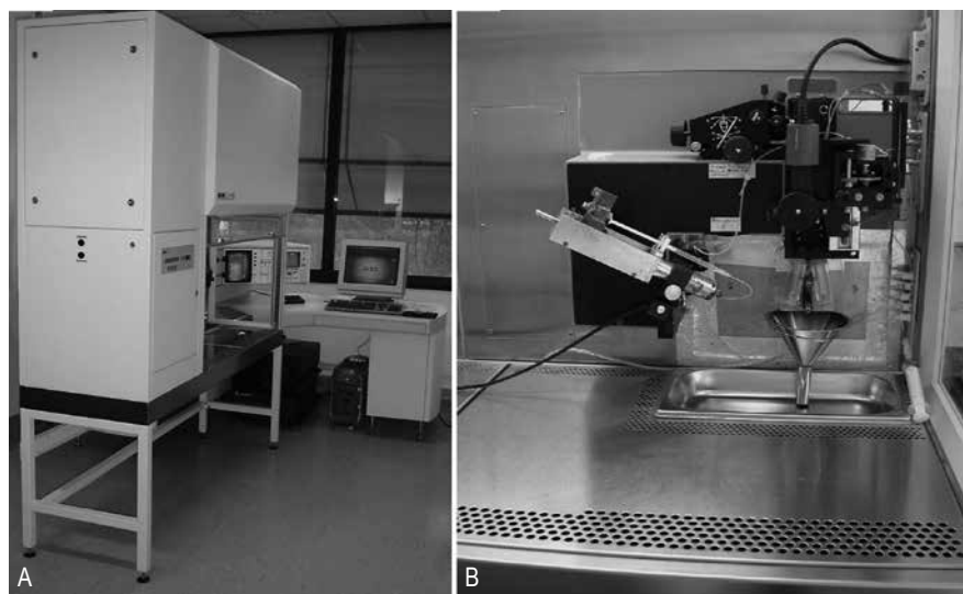
(3) A: FACSVantage Zellsortier-Anlage, angepasst und verbunden mit einer Sicherheitswerkbank nach Klasse II, B: Sortierkammer und Teile der Zellsortier-Anlage (optische Komponenten zur Strahlführung, Justage-Elemente und Probenzufuhr) innerhalb des Arbeitsraums.
