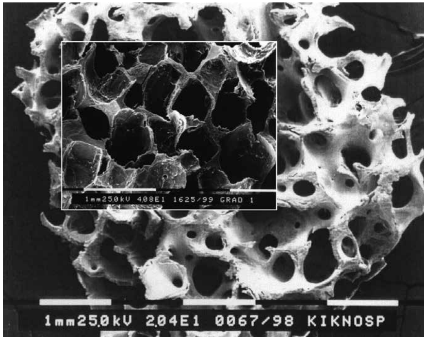
(1) Poröses Polyglycolid zum Knochenersatz. Großes Bild: Natürlicher Knochen. Einschub kleines Bild: Künstlicher Knochen (ein weißer Balken entspricht 1 mm). Neben den dargestellten Poren im Bereich von 0,1 bis 1 mm enthält der künstliche Knochen auch Poren in der Größenordnung von wenigen Mikrometern, die hier nicht aufgelöst sind. Quelle: Fabian Peters
