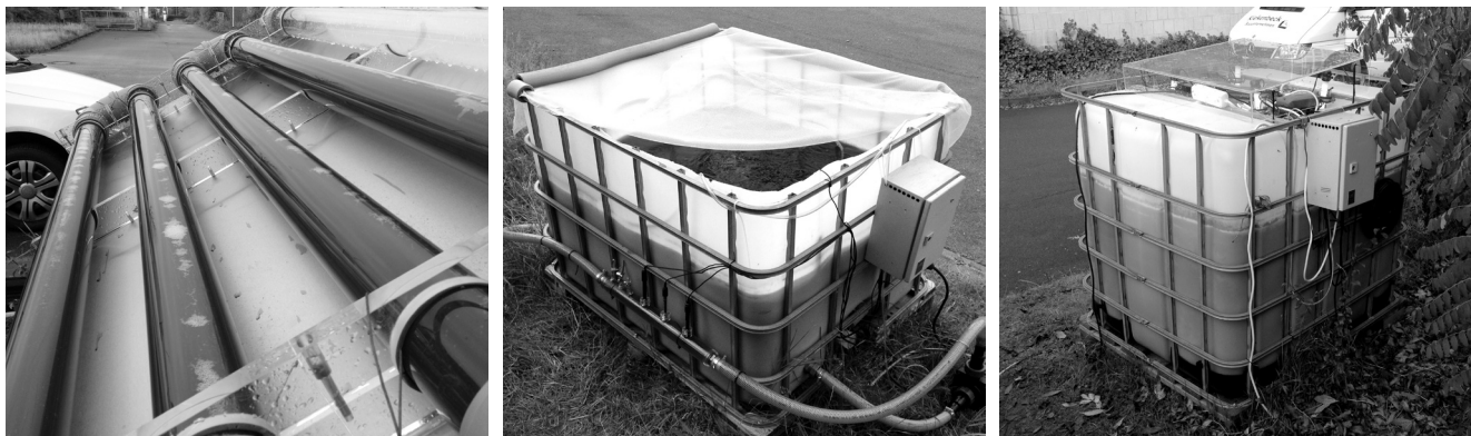
(3) Links: Rohrphotobioreaktor, Mitte: offener Wassertank IBC, rechts: Wassertank IBC mit Leuchtstoffröhren. Quelle: Pozza [20]
