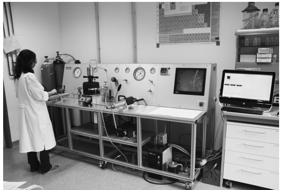
(1) Hochdruckanlage zur Simulation von Verhältnissen innerhalb der Erdkruste bis 10 km Tiefe. Die eigentliche Hochdruckzelle befindet sich in dem schwarzen Zylinder links von der Bildmitte. Sie erlaubt die kontinuierliche Beobachtung von Reaktionen sowie die Zugabe und Entnahme von Substanzen bei einem konstanten Druck von bis zu 1.000 bar.
