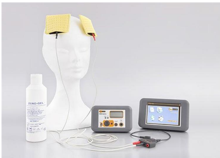
Abbildung 2: DC-Stimulationssystem (HDCkit): Von rechts nach links; Programmierer (HDCprog), Stimulator (HDCstim) und Elektrodenset (HDCel) bestehend aus zwei Silikonelektroden, zwei Celluloseschwämmen und Gel zum befeuchten (The Magstim Company Ltd - UK 2018).
