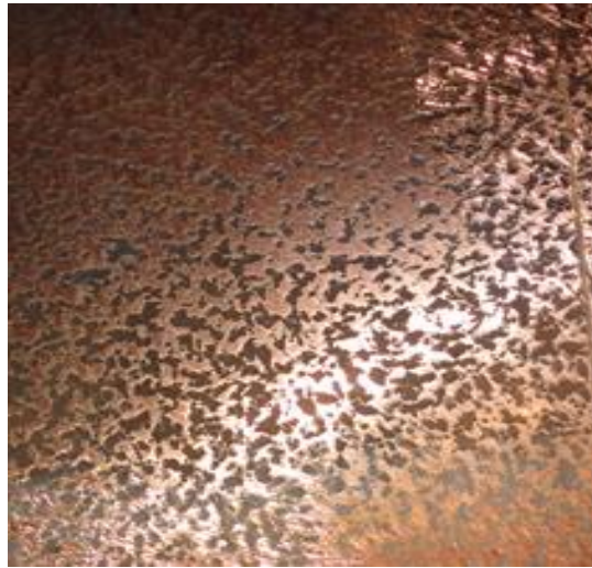
Abbildung 7.8: Makroaufnahme der Oberflächenmodifikation nach Einsatz der Kokille.
