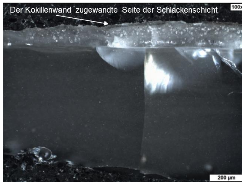
Abbildung 9.7: Mikroskopische Aufnahme einer der in Abbildung 9.6 gezeigten Proben.
