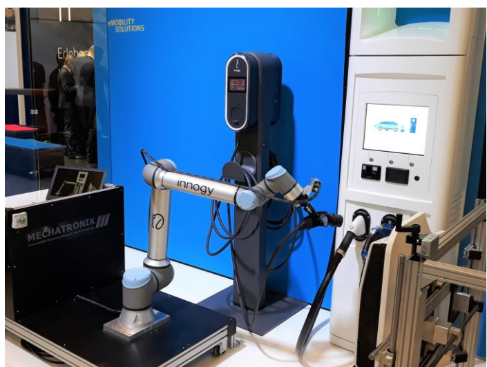
Abb. 1: Erster Funktionsdemonstrator eines automatisierten Ladesystems während der Messe „E-World – energy and water“ in Essen im Februar 2019 [5]
