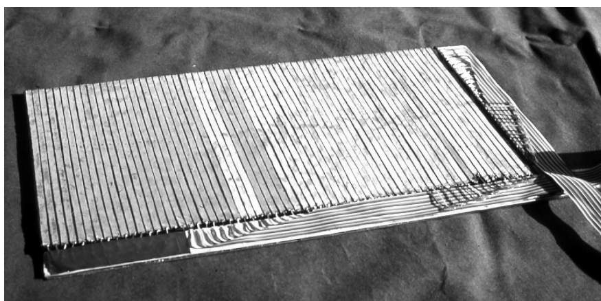
(1) Kapazitive Druckverteilungsmessmatte mit 2048 Sensoren. Quelle: eigenes Foto
