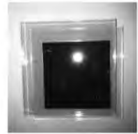
(10) Schematischer Aufbau (links, Seitenansicht) und Foto (rechts, Draufsicht) einer Farbstoff-Solarzelle. Die Beschreibung im Text bezieht sich auf die Glas/Titandioxid-Elektrode auf der linken Seite im schematischen Aufbau.
