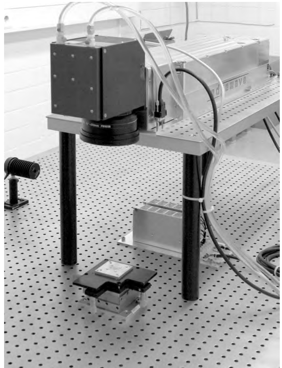
(11) Hochleistungslaser zum definierten Sintern von Nanopartikelschichten.
