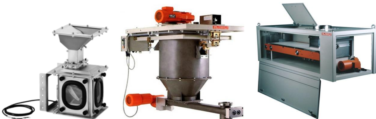
Abb. 1 Messschuppenwaage (links) 1 erfasst die Fördergeschwindigkeit durch Differenzieren der resultierenden Beschleunigungskraft des abrutschenden Produktes nach der Zeit. Integralwaage (mittig) 2 Abnahme des Systemgewichts pro Zeiteinheit. Bandwaage (rechts) 3 Die Geschwindigkeitsabnahme erfolgt über inkrementelle Drehgeber an dem Förderbandantrieb.
