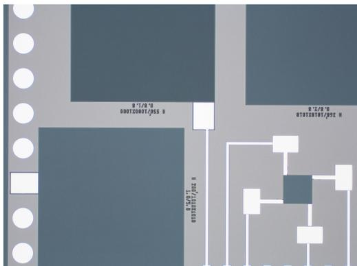
(a) Mikroskop-Aufnahme einer Löcher-Struktur und einer elektrischen Test-Struktur
