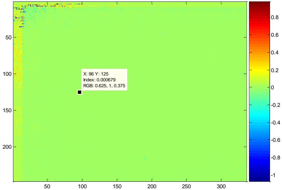
Abbildung 74: Beispiel eines QVGA Bildes mit den farbcodierten Vakuumsensormesswerten für jedes Pixel zwischen zwei Messzeitpunkten, bei dem die globale Drift herausgerechnet wurde (Index = 0)
