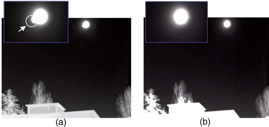
Abbildung 29: Einpunkt-Kalibration bei solar-induziertem Memory-Effekt: (a) Sonnen- spur nach 2 min Einstrahlung; (b) Sonnenbild nach einer Einpunkt-Kalibrierung [25]
