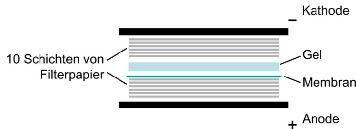
Abb. 2.3 Schema vom Blotting-Sandwich für den Elektrotransfer von DNA.
