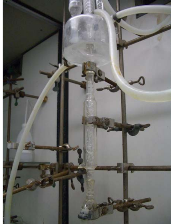
Abb.4.5.1-3: Mittlerer Aufbau mit nach dem Dreihalsaufsatz geschalteter Vigreux-Kolonne.
