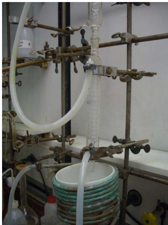
Abb. 4.5.1-4: Nach der Vigreux-Kolonne geschalteter Schlangenkühler mit temperierbaren Büchner-Trichter.
