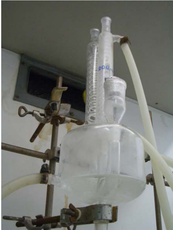
Abb.4.5.1-2: Oberer Aufbau der Fällungsanlage mit zwei Schlangenkühlern, Reduzierstück und temperierbaren Dreihalsaufsatz.
