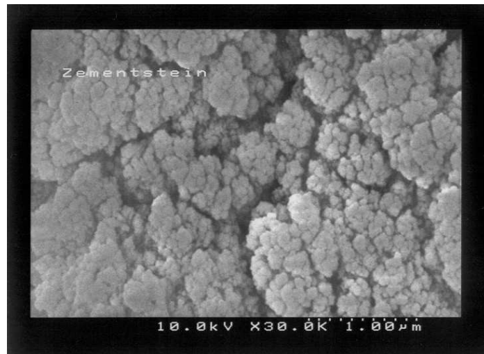
Abbildung 22: Demgegenüber REM-Aufnahme einer unbehandelten, geschnittenen Zementsteinoberfläche
