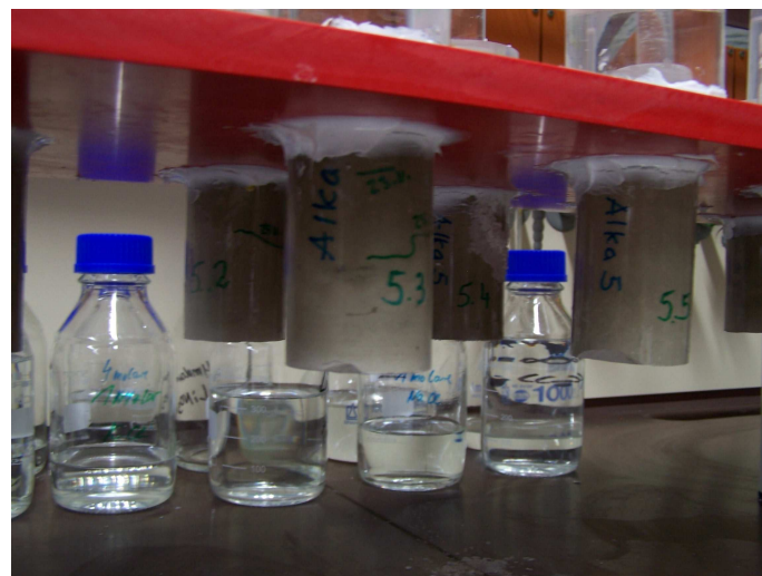
Tafel 3: Untersicht der Proben bei Zufuhr der Lösungen; Markierungen für das Vordringen der Wasserfront
