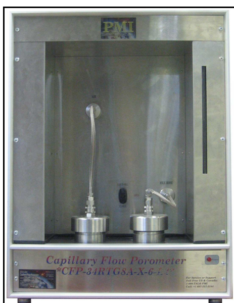
Abb. 4-6. Durchströmungsporometer der Firma PMI.
