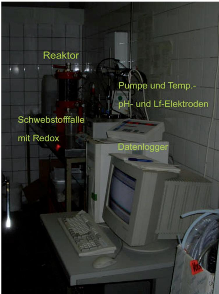
Abb 9-2: Versuchsaufbau einfacher Inkubationsversuch mit Reaktor.
