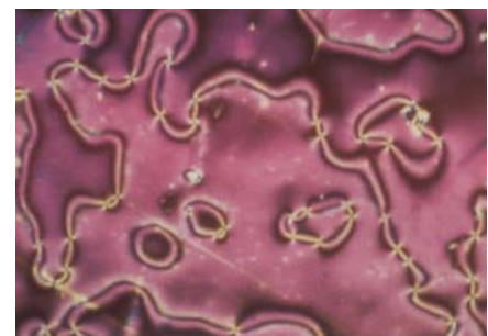
Abb. 1.3 Mikroskopische Polarisationsaufnahme einer nematischen Phase 7
