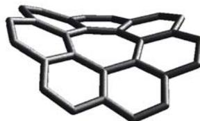
Abb. 2.8: *Dreidimensionale Darstellung eines Heptagon-Defektes, der zu einer sattelartigen Struktur führt.*
