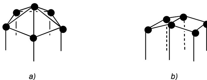
Abb. 2.7: Darstellung von Verschußarten für Kohlenstoffröhren. Das erste Bild zeigt eine symmetrische Geometrie (a), bedingt durch eine symmetrische Anordnung von Pentagonen, das zweite eine unsymmetrische (b). Die schwarzen Punkte stellen jeweils einen Pentagonddefekt dar.<sup>[20]</sup>
