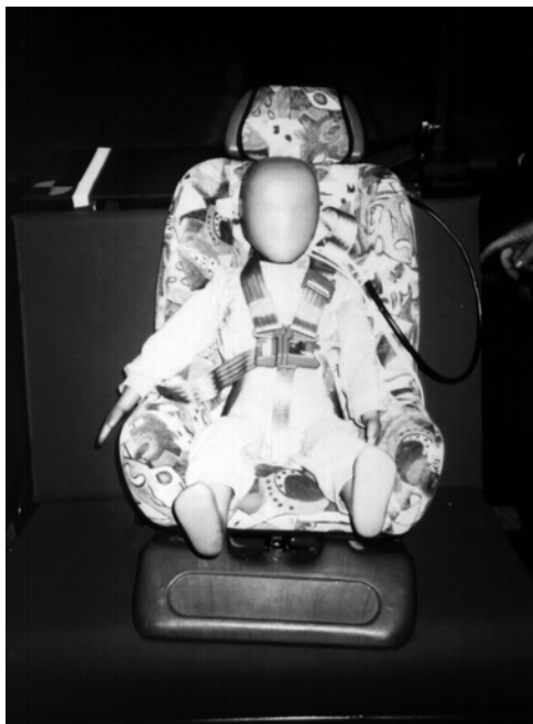
Abb. 6.41 : Kinder-Dummy in Kinderrückhaltesystem
