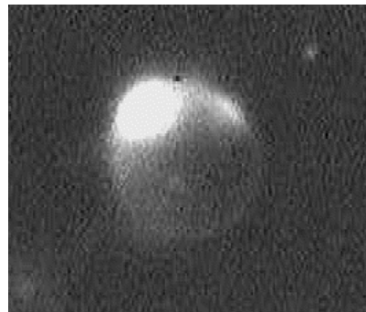
Abbildung 2-16: Fluoreszenzmikroskopische Aufnahme eines DMPC-Vesikels ( d = 10.2 \mu\text{m} ) nach Anregung im UV-Bereich. Das Bild verdeutlicht die Anreicherung von Pyren im Bereich phasenseparierten Toluols (heller Bereich) in der Doppelschicht.
