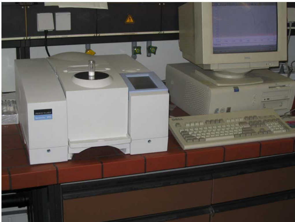
Abbildung 3.2.3: Probenmessung mit dem NIR Spektrometer Spectrum One NTS
