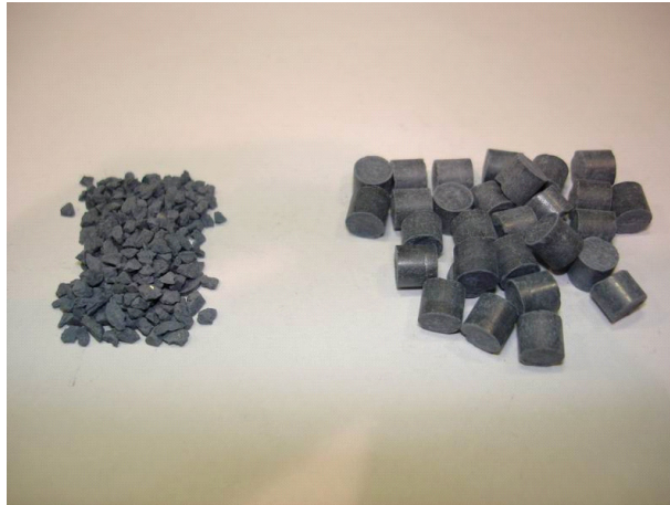
Abb. 6-2: ZnO in der eingesetzten zerkleinerten Form und der kommerziell erhältlichen Tablettenstruktur
