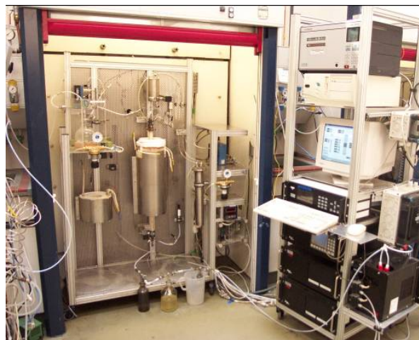
Abb. 14-28: Bild des Katalytischen Cracker-Versuchsstandes mit Analytik
