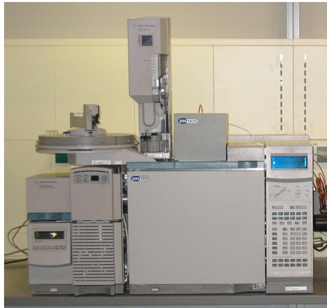
Abb. 12-1: GC/MS der Fa. Agilent Technologies
