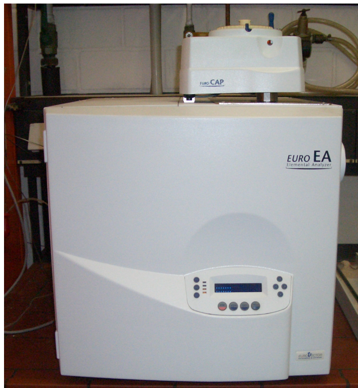
Abb. 12-2: Elementaranalyse-Messgerät Euro EA
