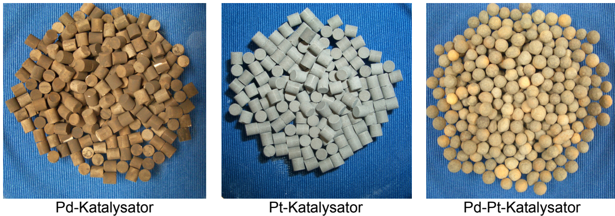
Abb. 4-1: Fotografische Darstellung der verwendeten Edelmetall-Katalysatoren
