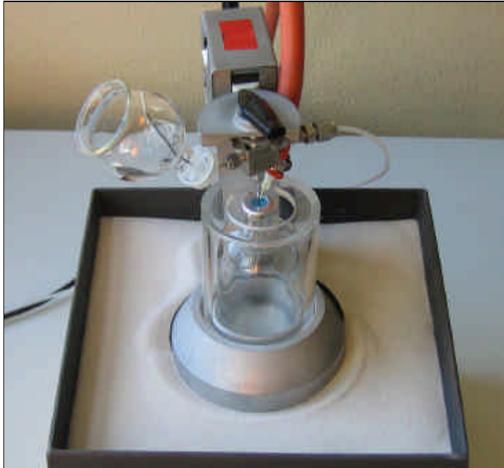
Abbildung 25: Olfaktometerstand nach LABC-Labortechnik (optional: beheizbares Sandbad).
