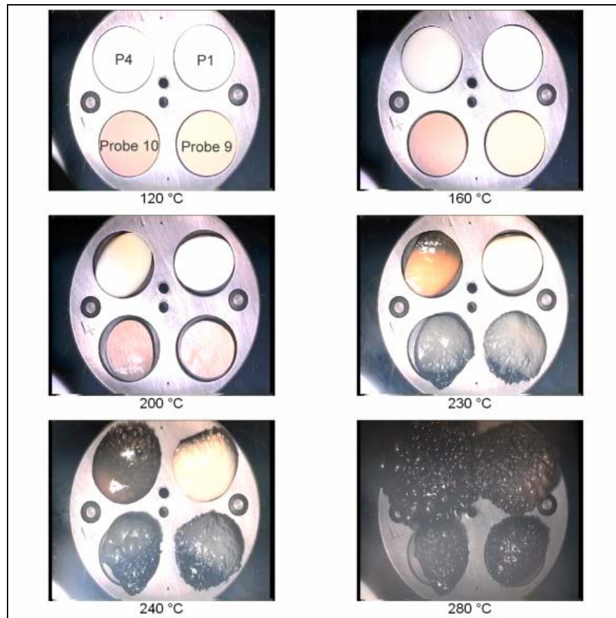
Abbildung 5.33 Videobilder der thermooxidativen Zersetzung von P4, P1, Probe 9 und Probe 10 unter synthetischer Luft
