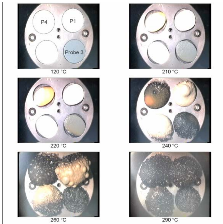
Abbildung 5.31 Videobilder der thermooxidativen Zersetzung von P4, P1 und Probe 3 unter synthetischer Luft
