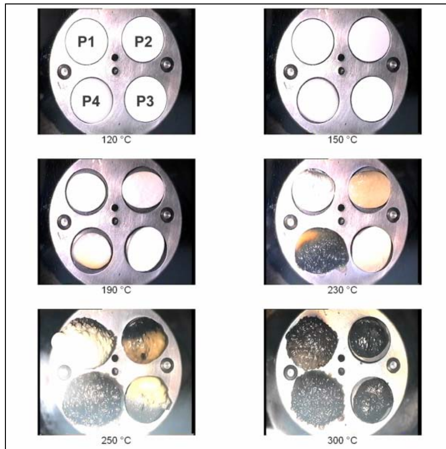
Abbildung 5.26 Videobilder der thermischen Zersetzung von P1, P2, P3 und P4 unter Argon
