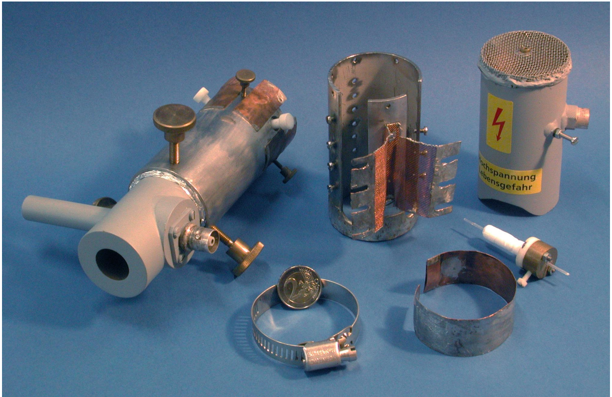
Abbildung 13.2-4: Surfatron nebst Abschirmung, Lichtleiterbefestigung und Zündvorrichtung für das Plasma
