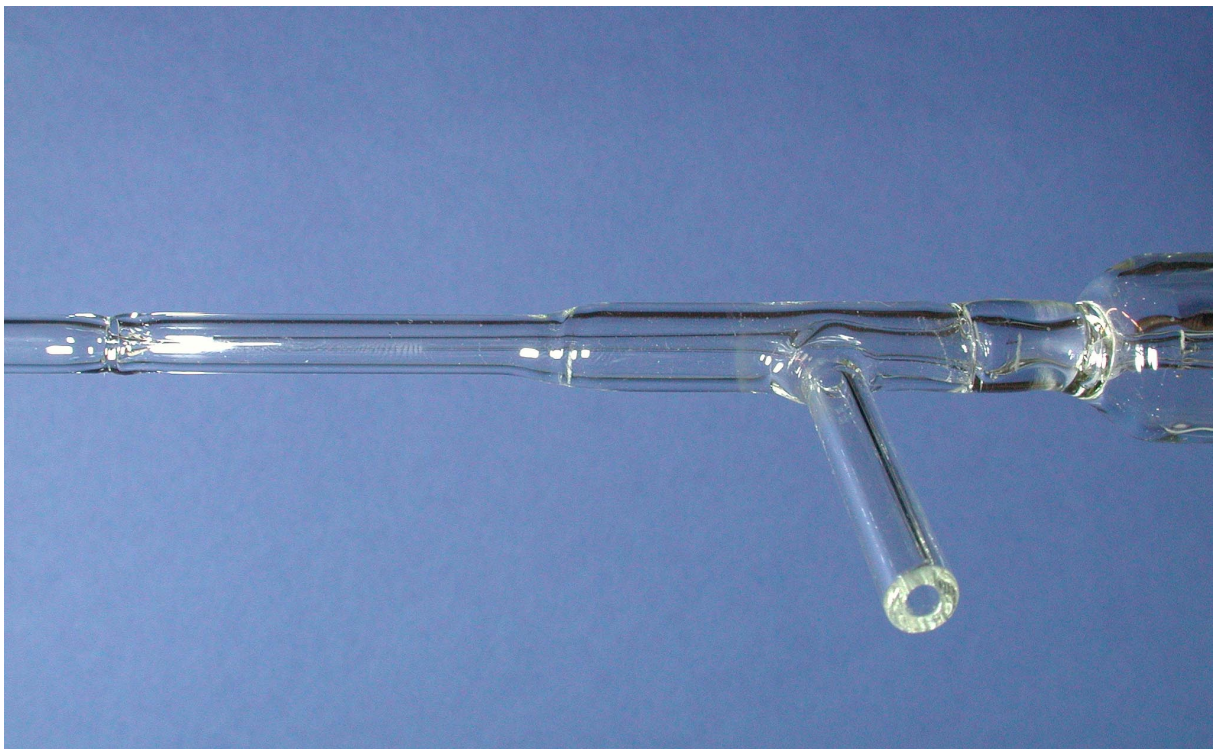
Abbildung 13.2-9: Probeneinlasskapillare der offenen Kopplung und Sauerstoffeinlassstutzen
