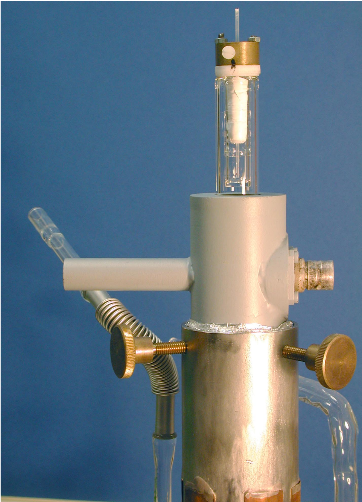
Abbildung 13.2-3: Lichtleiterbefestigung am Entladungsrohr
