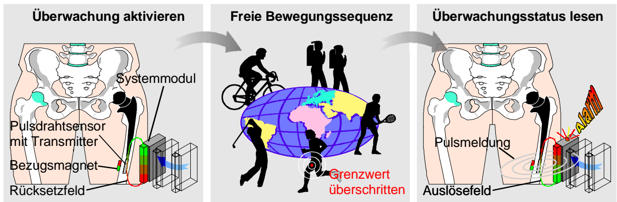
Bild 5.20: Konzept zur qualitativen Überwachung von Relativbewegungsgrenzen am Knochen-Prothesen-Verbund auf der Basis von Pulsdrahtsensoren
