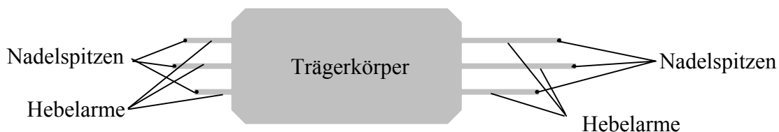
Bild 4.3: Schematische Abbildung eines Multilever-Chips
