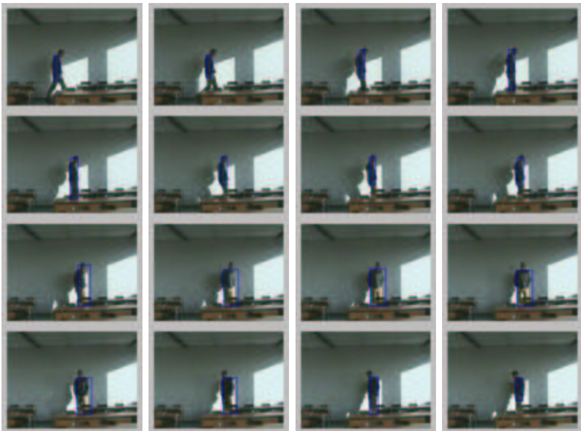
Abbildung 5.19: Ausschnitt aus einer Bildsequenz, die eine sich bewegende Person zeigt. Die blau eingezeichneten Rechtecke visualisieren das Trackingergebnis (aus [Win98]).
