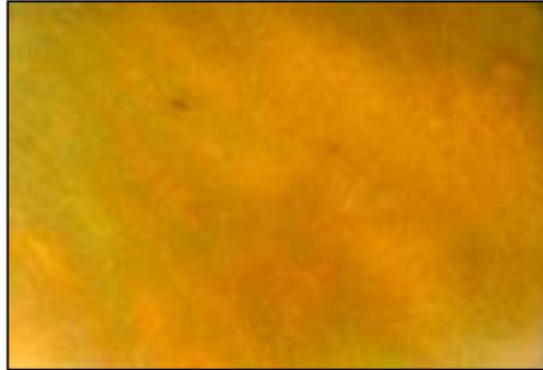
Bild 5: Smektische Schlieren Textur von DMD bei 230°C, 320 fache Vergrößerung.
