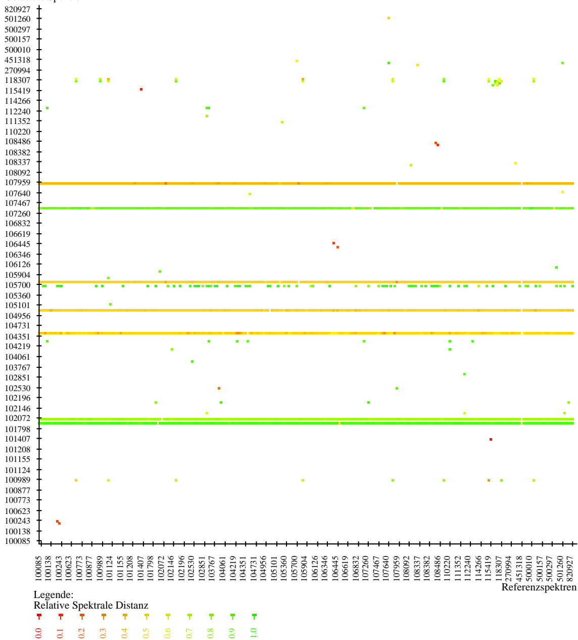
Abb. R24: Standardmethode (Vektornormierung, 1. Ableitung, 3500\text{ cm}^{-1} bis 200\text{ cm}^{-1} ).
