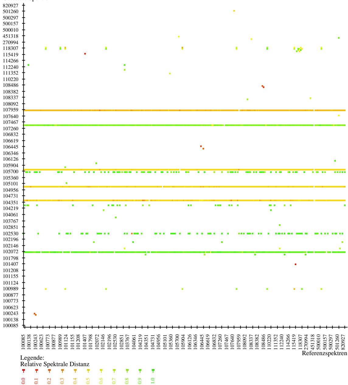
Abb. R25: Standardmethode (Vektornormierung, 1. Ableitung, 3300\text{ cm}^{-1} bis 100\text{ cm}^{-1} ).
