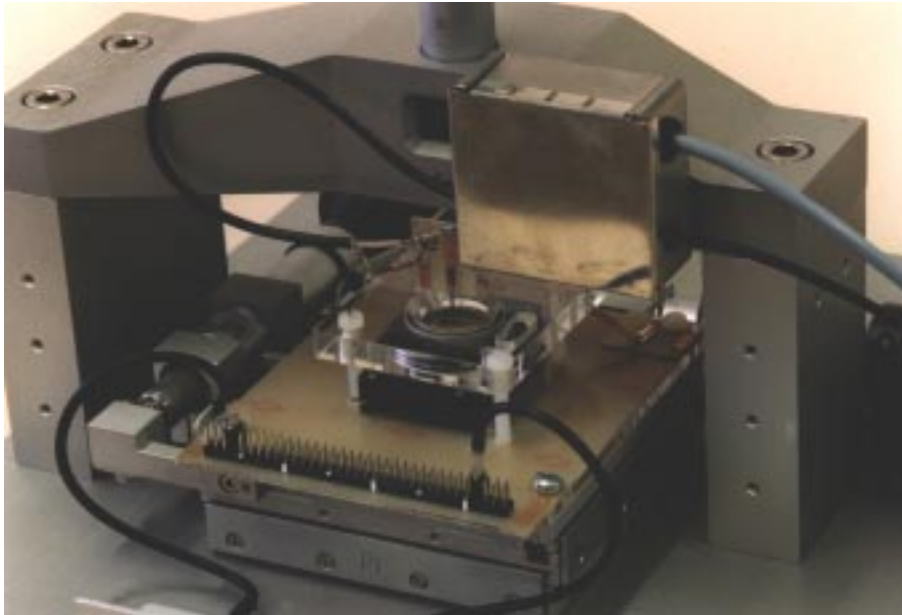
Abb. 5.18: Eine Detailsicht auf die Positionierung in der Badkammer
