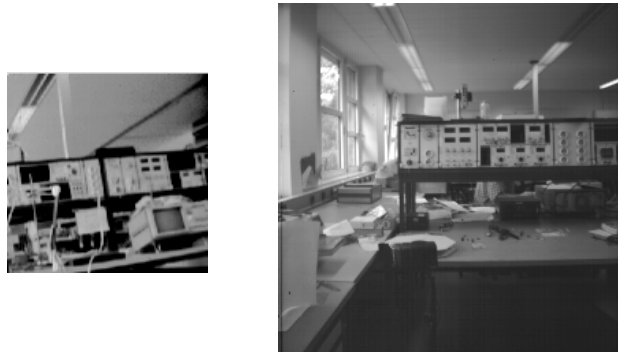
Abbildung 6.5: Testbilder, die mit dem entwickelten 128 \times 128 Pixel CMOS-Bildsensor bei einer Bildrate von 100 Hz und 9 ms Integrationszeit (links) und mit dem entwickelten 256 \times 256 Pixel CMOS-Bildsensor bei einer Bildrate von 200 Hz und 4 ms Integrationszeit (rechts) aufgenommen wurden.
