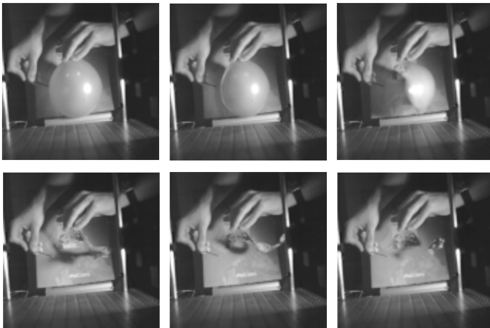
Abbildung 6.4: Sequenz von aufeinanderfolgenden Bildern eines platzenden Ballons aufgenommen mit dem 256 \times 256 Pixel CMOS-Bildsensor bei Integrationszeiten von 100 \mu\text{s} und einer Bildrate von 1040 Bilder/s.
