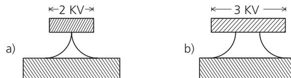
**Abbildung 4.4:** Zusammenhang von Auflösung  $AL$  und Kantenverschiebung  $KV$ . a) aufgelöste Strukturbreite gleich Null; b) aufgelöste Strukturbreite gleich  $KV$
