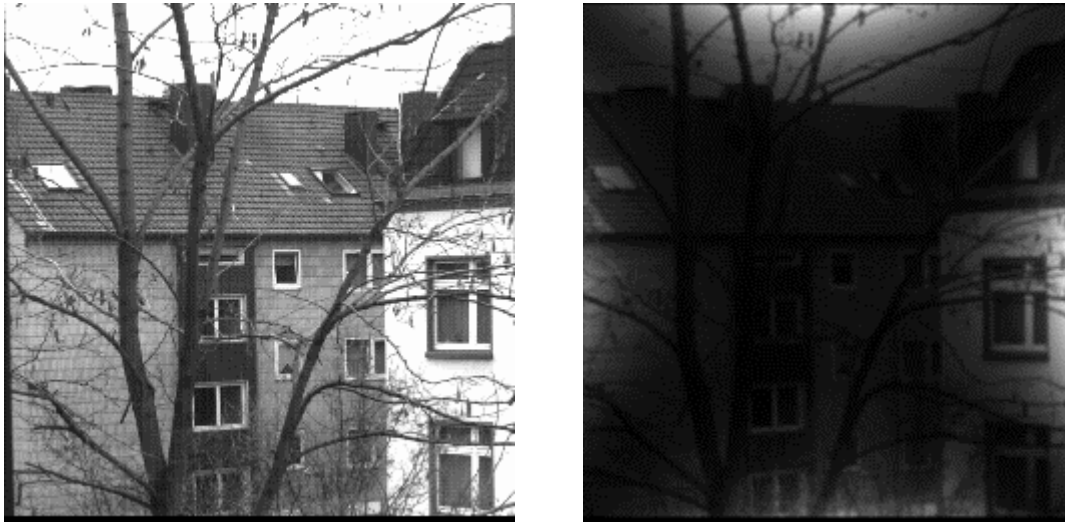
Abbildung 3.10: Originalszene (links) und multipliziert mit Helligkeitsgradient (rechts) zur Untersuchung der Filteralgorithmen
