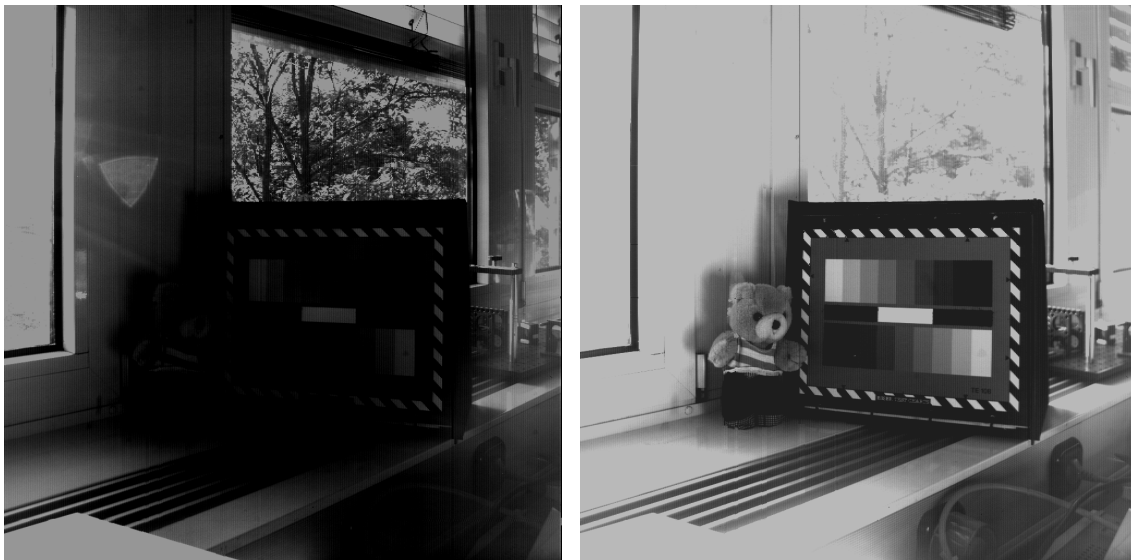
Abbildung 5.16: Aufnahmen mit Mehrfachintegration (links: 640\mu\text{sec} , rechts: 20\text{ms} )
