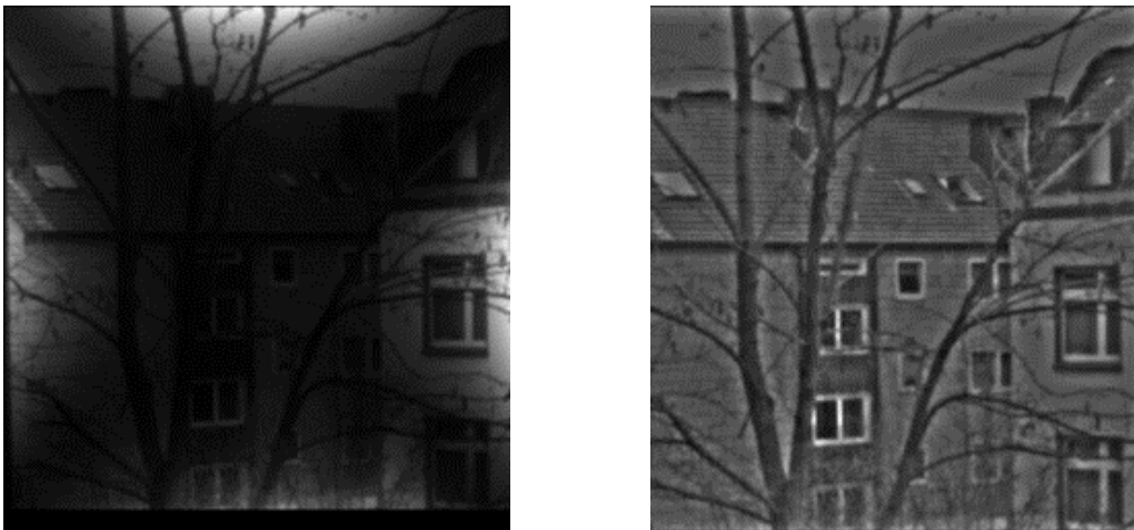
Abbildung 3.12: Natürliche Szene einer Textur mit hineinmultipliziertem Helligkeitsgradienten (links) und Filterung mit 17x17 Filterkern (rechts)
