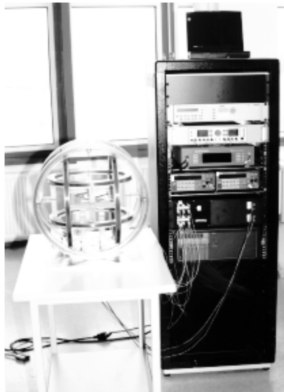
Abb. 4.54: Ansicht des Magnetfeldsondentesters mit Helmholtzspule
