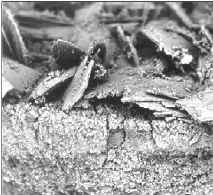
**Bild 90: REM-Aufnahme quer zu einer Bruchstelle der ZM-Oberfläche aus der Versuchsstrecke vor Inbetriebnahme (Vergrößerung = 200)**
