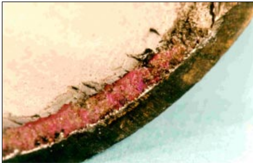
Bild 41: Phenolphthaleintest an der Bruchstelle eines mit der 2-Stufen-Konditionierung behandelten ZM-Rohres DN 200
