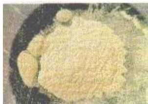
Abb.6: Ein unregelmäßig aufgehäuftes Granulat tendiert bei kleiner Amplitude dazu "auseinanderzulaufen".
