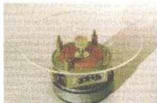
Abb.5: Ein sinusförmig schwingender Lautsprecher kann ausgenutzt werden, die auf einer Platte aufgetragenen Bärlappsporen in Vibration zu versetzen. Hier ein handelsübliches Gerät der Lehrmittelindustrie.
